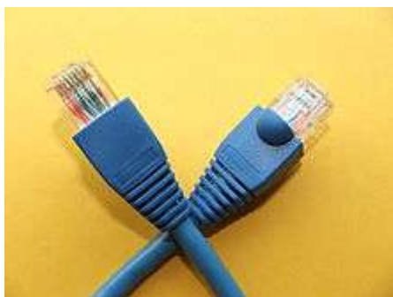
Connecteur RJ45 servant à la connexion des réseaux informatiques via Ethernet
